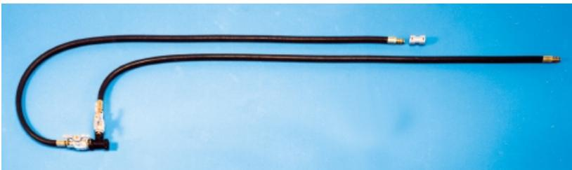
Проложенные для подачи двух компонентов шланги также оборудованы штекерным соединителем и по желанию могут быть удлинены до нужного расстояния. В месте непосредственного нагнетания шланги подсоединяются к Т-образной муфте, в которой встречаются компоненты А и Б, и подаются дальше в досыпающую систему уже совместно. Для этого существуют следующие возможные варианты:
