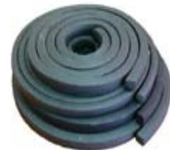
Бентонит натрия, входящий в состав шнура при контакте с водой гидратируется, поглощая из окружающего пространства воду, что приводит к его объемному расширению. Находясь в ограниченном для свободного набухания пространстве, в полости шва возникает противодействие, которое позволяет воспринимать значительное внешнее гидростатическое воздействие на герметизируемый узел конструкции. Кроме того, надежная герметичность сохраняется даже при динамических воздействиях с раскрытием швов до 0,25 мм.
